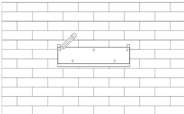
Perfure com uma furadeira elétrica, certifique-se de que os furos tenham pelo menos 50 mm de profundidade e, em seguida, aperte os tubos de expansão.
