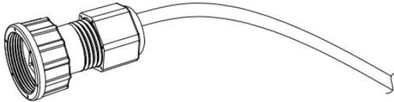
Passo 2: Recrute o cabo com um plugue Rj45 que está dentro do conector de cabo.
