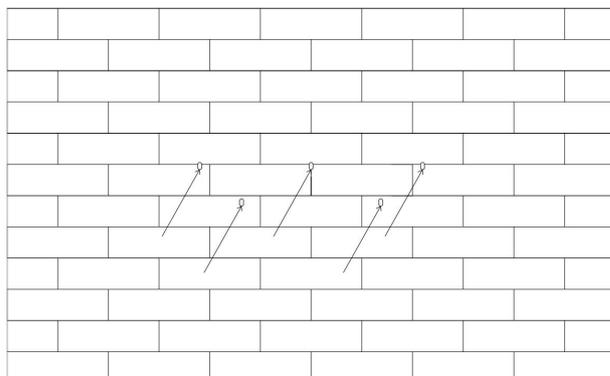
Insira os tubos de expansão nos furos e aperte-os. Instale o suporte com os parafusos de expansão.
