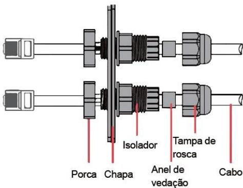
Passo 3: Insira o conector do cabo na porta DRM/COM da parte inferior do inversor e parafuse-o firmemente. Em seguida, insira a outra extremidade do cabo de network no PC ou outro dispositivo.
