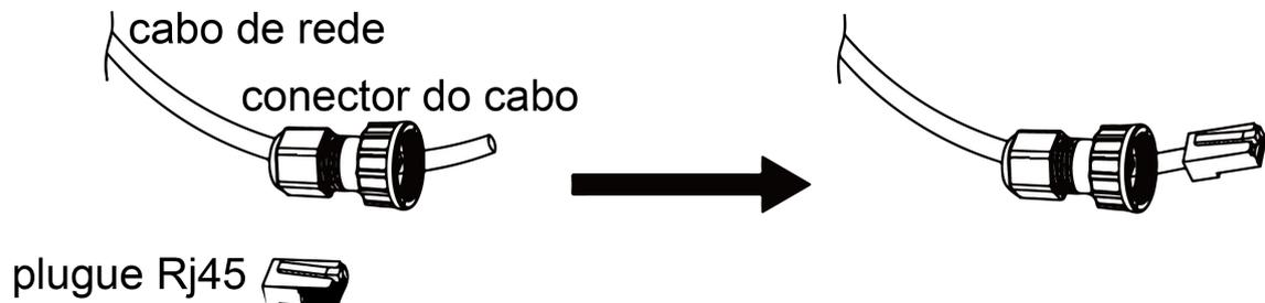
Passo 3: Insira o conector de cabo na porta BMS na parte inferior do inversor e aperte-o firmemente.
