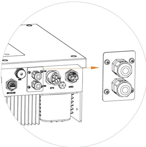
Passo 2: Prepare um cabo da rede padrão e um conector de cabo e, em seguida, insira o cabo de rede pelo conector de cabo.
