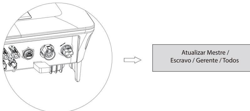
Figura 5.31: Inserção do pendrive na porta WiFi/GPRS/4G/USB
