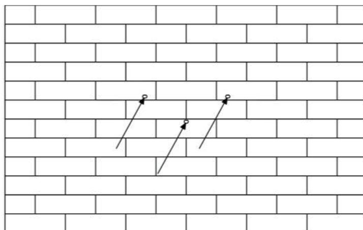
Figura 5.6: Execução dos Furos para Parafusos do Suporte
