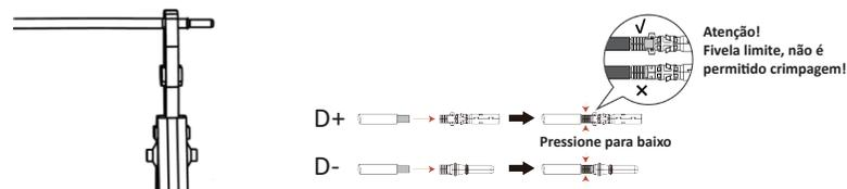
Figura 5.12: Cripagem de Cabo CC com Alicate Adequado
